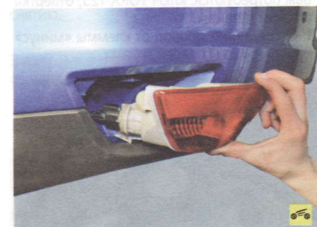
3. ...и извлеките противотуманный фонарь из бампера.
