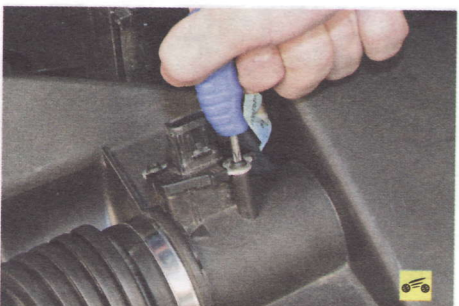
5. Выверните два винта крепления...
