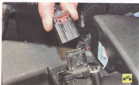
4. ...и отсоедините колодку жгута проводов от датчика.
