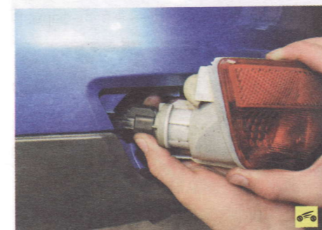
4. Поверните патрон лампы против часовой стрелки...
