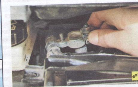
7. Снимите наконечник провода с клеммы «минус» аккумуляторной батареи.
