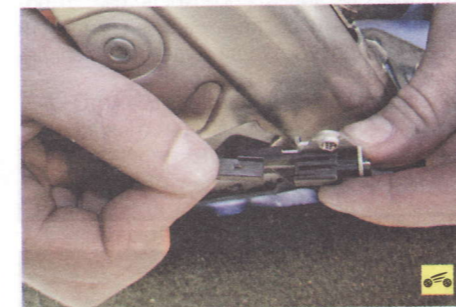
5. ...отсоедините колодку жгута проводов...
