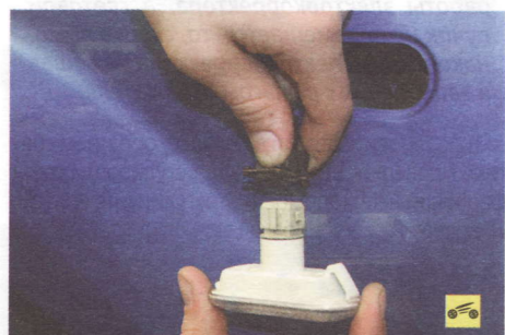
6. ...отсоедините колодку жгута проводов от патрона лампы...
