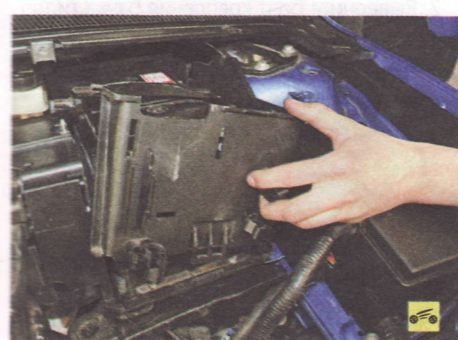
13. ...и снимите переднюю крышку аккумуляторной батареи.
