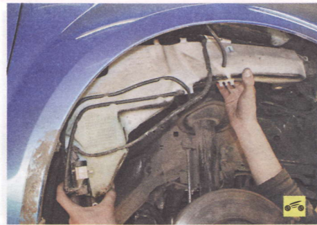
14. Сдвиньте вперед бачок омывателя и снимите его. 15. Слейте из бачка омывающую жидкость.
