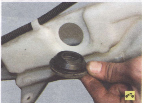
23. ...и извлеките уплотнительную втулку наливной горловины.
