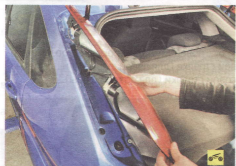
5. Отведите фонарь от кузова, преодолевая усилие фиксаторов.
