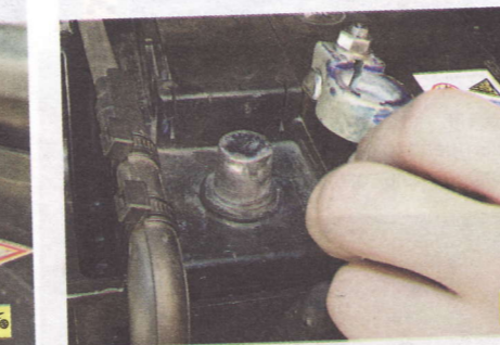
9. ...и снимите наконечник провода с клеммы «плюс» аккумуляторной батареи.
