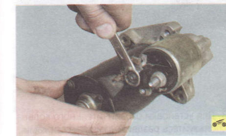
6. Выверните два винта...
