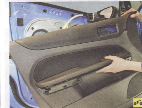
2. Снимите обивку двери (см. «Снятие и установка обивки передней двери», с. 245).
