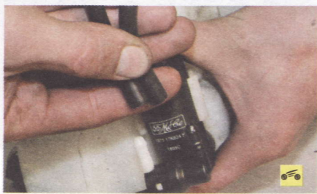
17. ...и отсоедините от насоса омывателя колодку жгута проводов.
