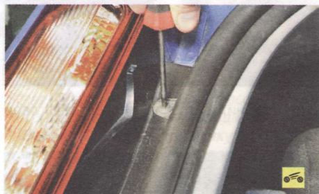
4. ...и верхний винты крепления фонаря...
