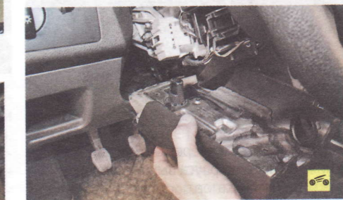
3. ...и нижнюю части кожуха рулевой колонки (см. «Снятие и установка кожуха рулевой колонки», с. 162).
