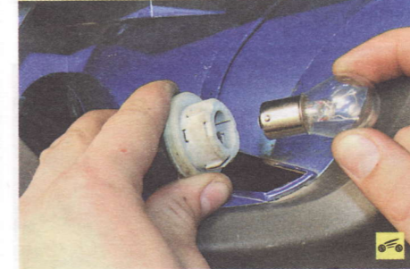
6. Поверните лампу против часовой стрелки...
