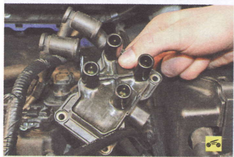
5. ...и снимите катушку зажигания. 6. Установите детали в порядке, обратном снятию.
