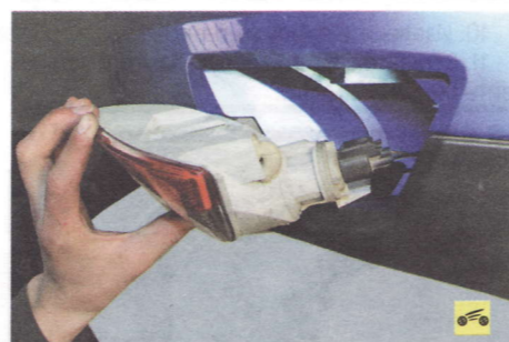
3. ...и извлеките фонарь света заднего хода из бампера.
