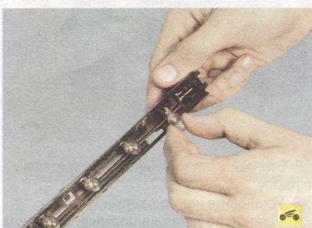
Соединение рассеивателя с патроном ламп уплотнено прокладкой. Поврежденную прокладку замените.
