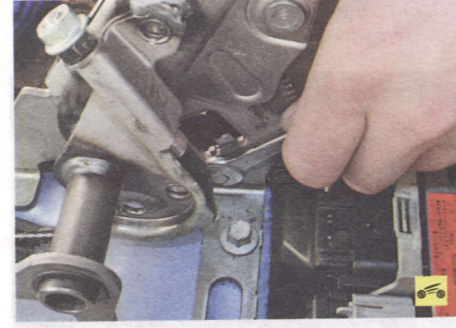
3. Выверните болт крепления выключателя сигнальной лампы включения стояночного тормоза.
