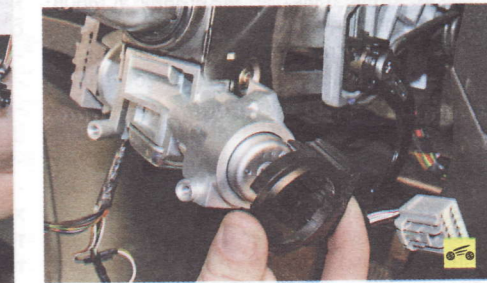
5. ...и отведите блок в сторону, не отсоединяя от него провод.
