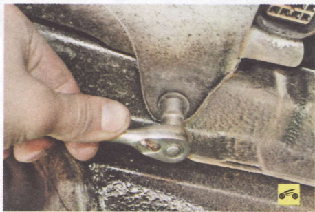
13. ...и передний болты крепления бачка омывателя.
