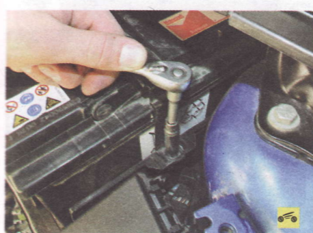
14. Отверните гайку крепления прижимной планки...
