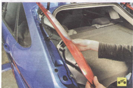
5. ...и отведите фонарь от кузова, преодолев усилие фиксаторов.
