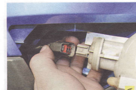
5. ...отсоедините колодку жгута проводов и снимите противотуманный фонарь.
