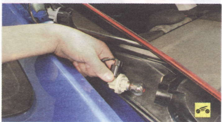
5. ...и отведите фонарь от кузова, преодолев усилие фиксаторов.
