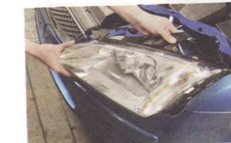
2. Снимите блок-фару (см. «Замена блок-фары», с. 214).
