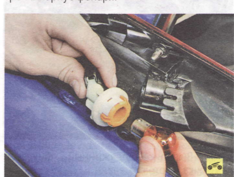
3. ...и извлеките фонарь света заднего хода из бампера.
