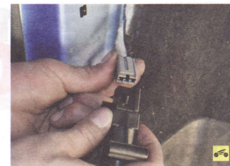
6. ...отсоедините колодку жгута проводов...
