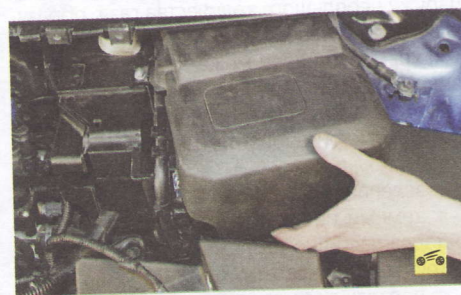
1. Поднимите вверх пластиковую крышку аккумуляторной батареи...
