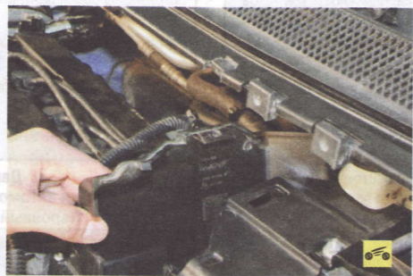
3. ...и снимите крышку блока управления двигателем.
