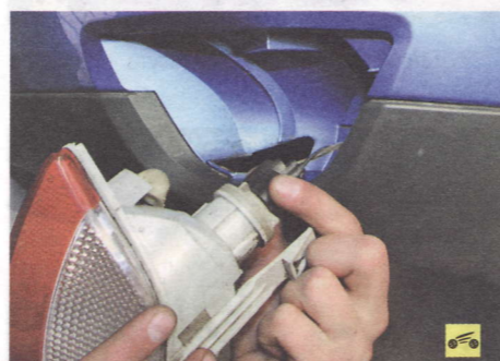
4. Поверните патрон лампы против часовой стрелки...
