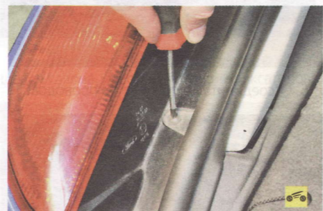
4. ...и нижний винты крепления заднего фонаря.
