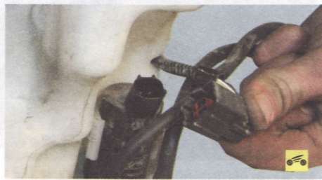
17. ...и отсоедините от насоса омывателя колодку жгута проводов.
