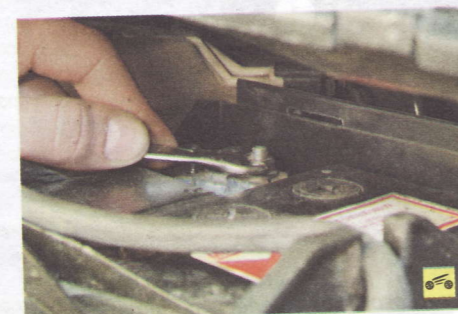
4. Ослабьте затяжку гайки стяжного болта наконечника «массового» провода.
