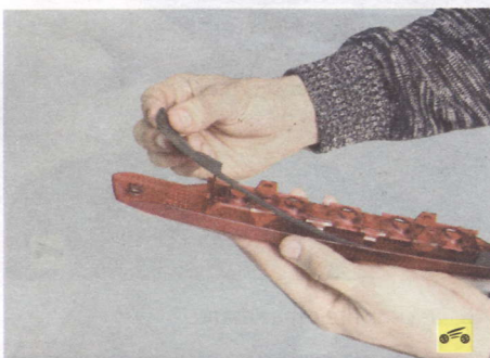
Соединение рассеивателя с патроном ламп уплотнено прокладкой. Поврежденную прокладку замените.
