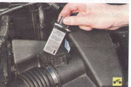
6. ...и снимите датчик массового расхода и температуры поступающего воздуха.
