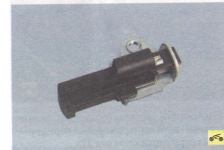
6. ...и снимите выключатель сигнальной лампы включения стояночного тормоза.
