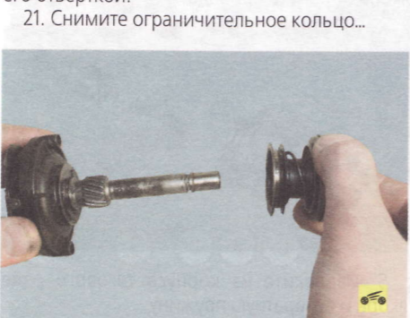
22. ...и привод с вала планетарного редуктора.
