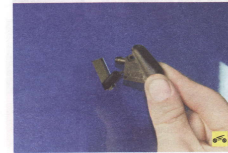
31. ...и снимите жиклер омывателя, вытаскив его жгут проводов через отверстие в капоте.
