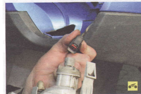
5. ...отсоедините колодку жгута проводов и снимите фонарь света заднего хода. 6. Установите фонарь света заднего хода в порядке, обратном снятию.
