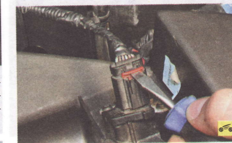
2. Отверткой поднимите вверх фиксатор колодки жгута проводов датчика.
