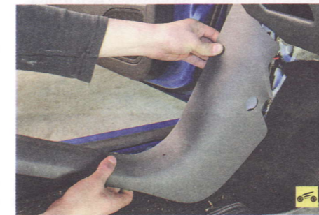
2. Снимите переднюю облицовку левого порога кузова (см. «Снятие и установка облицовок салона», с. 276).
