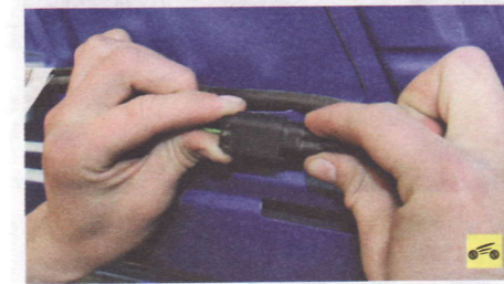
27. Для замены жиклера омывателя откройте капот, разъедините колодку жгута проводов жиклера...
