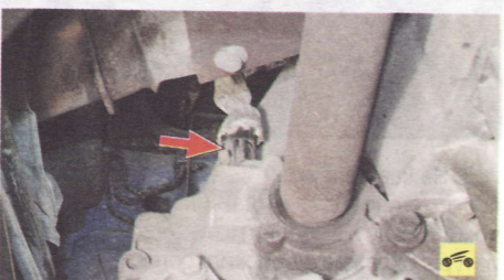
6. ...и снимите датчик массового расхода и температуры поступающего воздуха.
