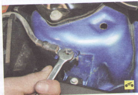
3. Выверните болт крепления «минусового» провода к «массе» кузова.
