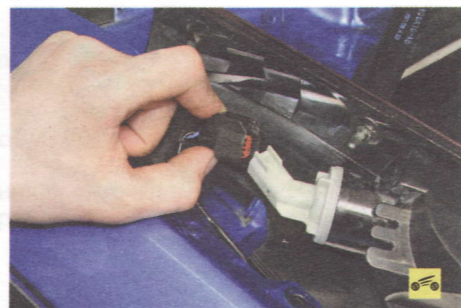
6. Сожмите фиксаторы и отсоедините колодку жгута проводов от патронов ламп и снимите задний фонарь.
