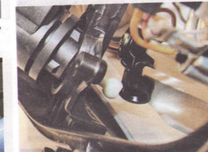
7. ...выведите шаровой наконечник из зацепления с пластмассовым рычагом отражателя...
