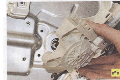
6. ...и снимите моторедуктор стеклоподъемника передней двери.
