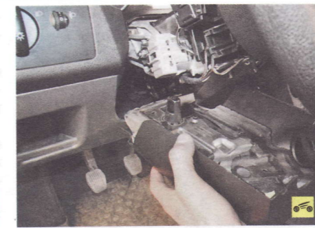
3. ...и нижнюю части кожуха рулевой колонки (см. «Снятие и установка кожуха рулевой колонки», с. 162).
