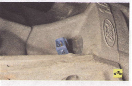
3. ...и отсоедините колодку жгута проводов датчика положения коленчатого вала.
