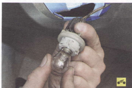
6. Поверните лампу против часовой стрелки...
