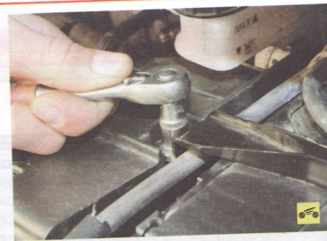
5. Отверните гайку крепления прижимной планки...
