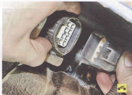
11. ...разъедините колодку и установите ее назад на кронштейн бачка омывателя.
