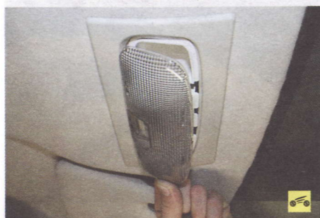
3. ...и снимите рассеиватель плафона освещения салона, преодолев усилие фиксаторов.
