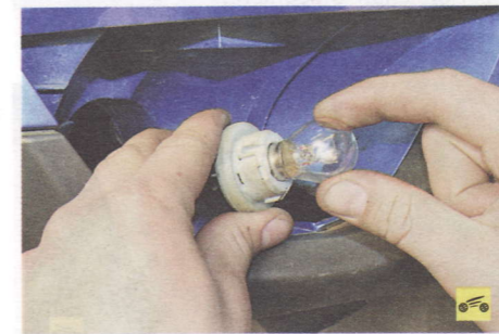
6. Поверните лампу против часовой стрелки...
