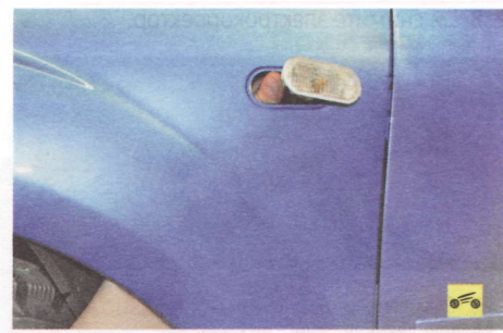
3. Просуньте руку между подкрылком и крылом, сожмите фиксатор и извлеките фонарь указателя поворота из отверстия в крыле.
