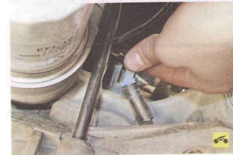
5. ...и извлеките датчик из отверстия в блоке цилиндров.
