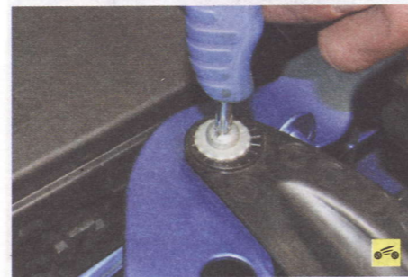
2. Выверните винт крепления блок-фары.
