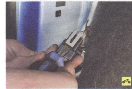
5. ...отожмите отверткой фиксатор...
