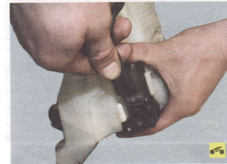
26. ...и снимите шланги, отсоединив их от насоса.
