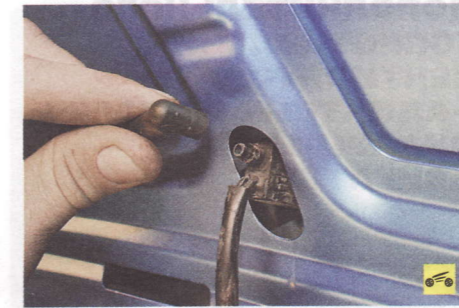
29. ...и отсоедините от жиклера шланг подвода жидкости.
