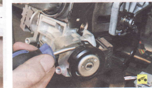
4. Отожмите отверткой фиксатор антенного блока иммобилизатора...
