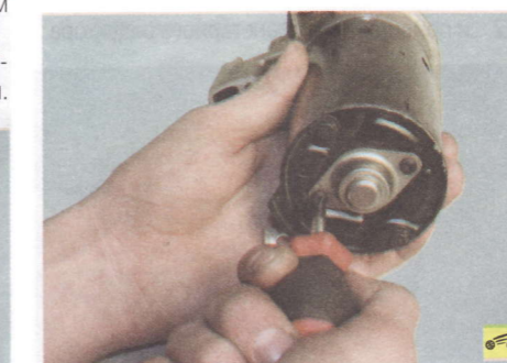
6. Выверните два винта...
