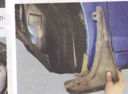
2. Снимите брызговик колеса (см. «Снятие и установка брызговиков колес и подкрылков», с. 235).
