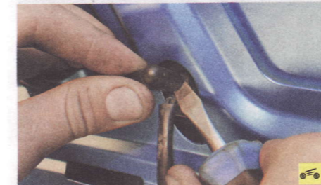
27. Для замены жиклера омывателя откройте капот, разъедините колодку жгута проводов жиклера...
