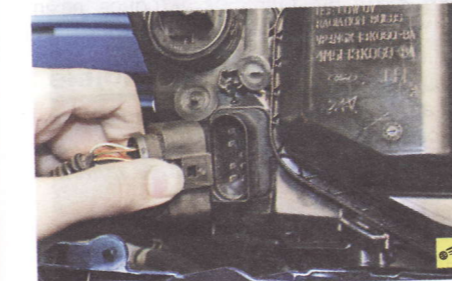
6. ...сожмите фиксатор, отсоедините колодку жгута проводов и снимите блок-фару.
