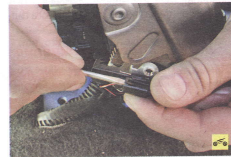
4. Отведите выключатель, отожмите отверткой фиксатор...
