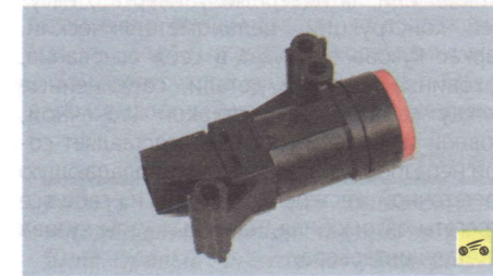
7. ...и снимите кнопку аварийного отключения подачи топлива.
